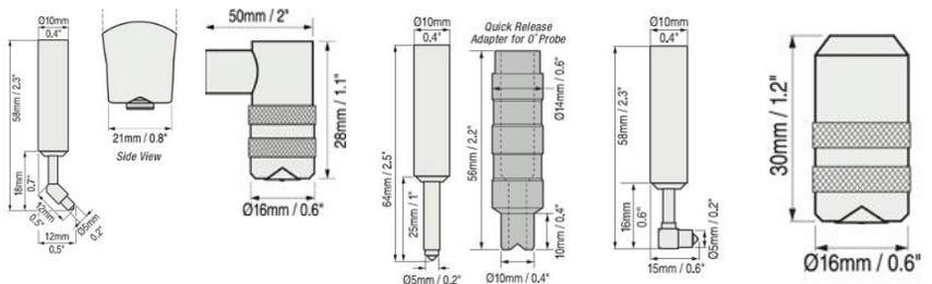
**Misuratore di spessore digitale per superficie verniciate a polvere od a liquido. Utilizzabile su materiali ferrosi o non ferrosi (es . Alluminio). Versione con sonda esterna per misurazioni su punti particolarmente difficili. Differenti versioni per tutte le esigenze.**
